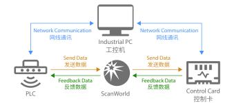
支持通过标准TCP/IP协议与PLC等工业控制器无缝通信。用户可通过网络直接向激光打标软件(ScanWorld)发送指令,实时触发预设打标任务,无需物理信号交互。
