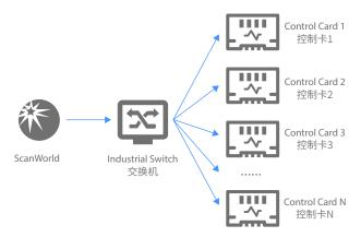
基于工业以太网网络架构,单台工控机可集中管理多达252 张激光控制卡。系统具备强大的多任务并行处理能力,支持所有接入控制卡同时、独立运行,差异化执行包含不同图形(如序列号、二维码、图案)及独立工艺参数(功率、速度等)的打标任务。极大提升产线吞吐效率与柔性生产能力,满足多品种、大批量同步打标需求。
